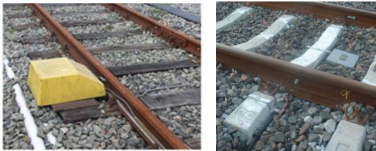
Afbeelding 17. Jade-Tuners: Links Jade 1, rechts Jade 2
